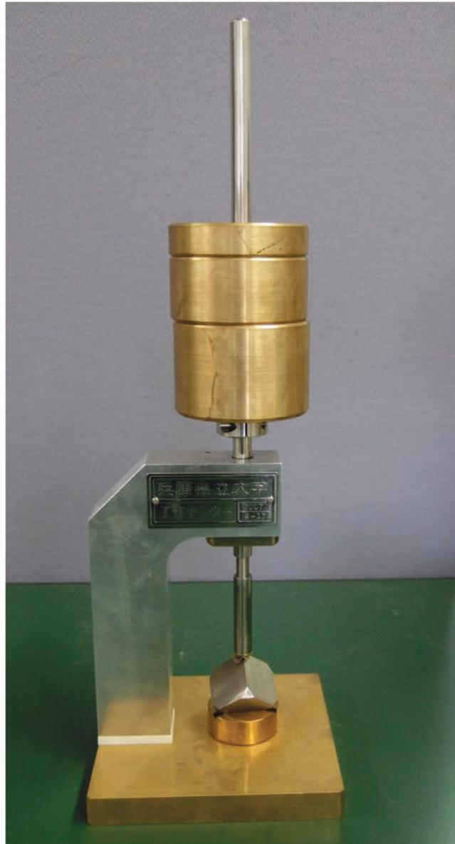
**Fig. 17** トランスデューサ接着用治具。荷重をかけてアンビル端面にトランスデューサを貼り付けるために使う。この治具ごとホットプレートに乗せ加熱しながら荷重をかける。アンビル端面に垂直に荷重をかけられるように角を支えられる受け治具がついている。
