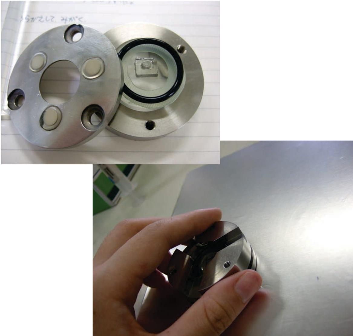
**Fig. 16** 試料などを研磨するための研磨治具。オプティカルグラスでおおまかな平行を保ち、Oリング(黒色のリング)を挟むことで高さの調節をしやすくした。アンビル端面の研磨治具と同様に三点のアルミナディスクの高さと中心の試料との高さを合わせて研磨する。
