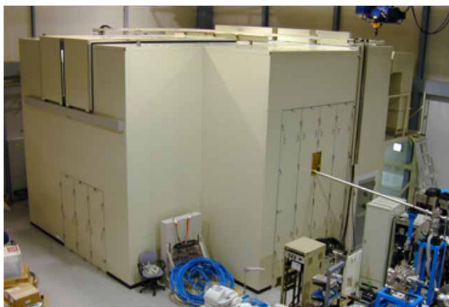
図 3-4-19 恒温チャンバーで覆われた EWMS
