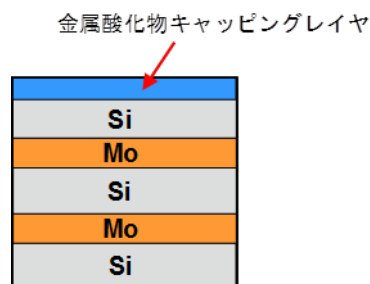
図 4-3-13 金属酸化物 capping layer 付き Mo/Si 多層膜
