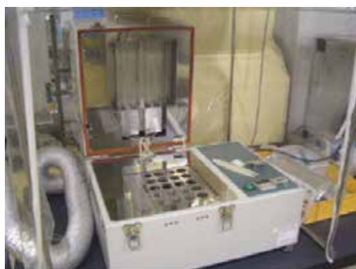
図 4-3-8 UV ドライ洗浄装置
