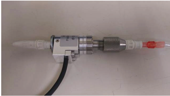
図 6-11. 6 軸力覚センサ Model: CFS018CA201U
