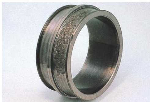
図 1.2 自動調心ころ軸受の内輪に発生したはく離 [出典：参考文献 2)]
