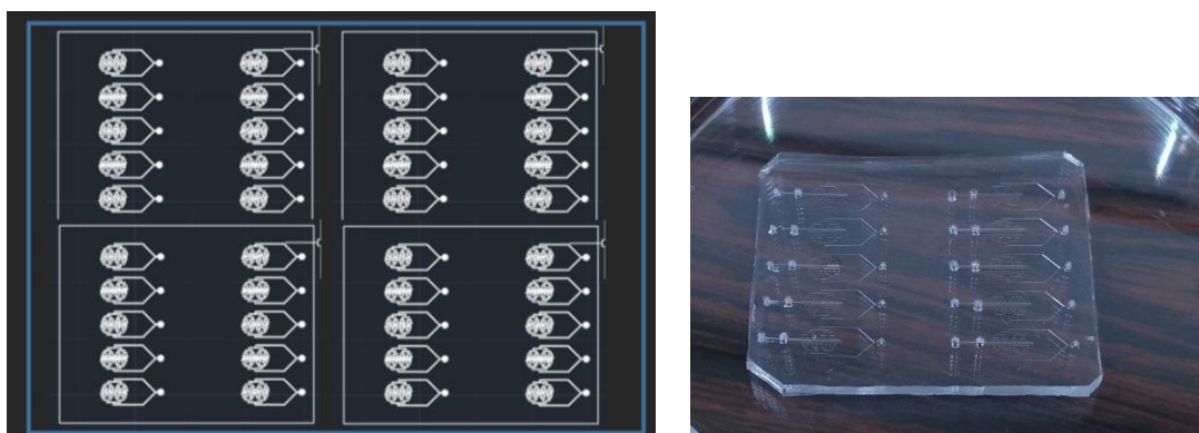
Figure 5-1 二次元化を行った結晶捕捉アレイ
