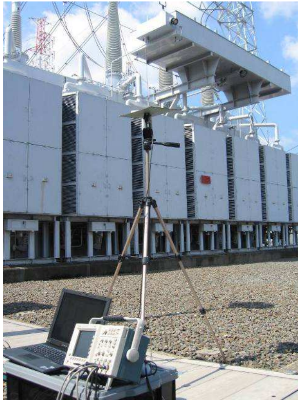
図 4.12 精密型部分放電診断手法の実施風景
