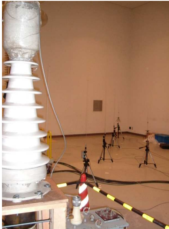
図 4.2 油入りブッシング除却品を用いた試験回路風景
